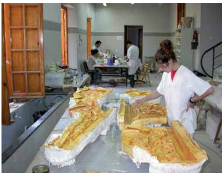
Figura 24. Aplicación de productos aislantes, endurecedores y desmoldeantes
