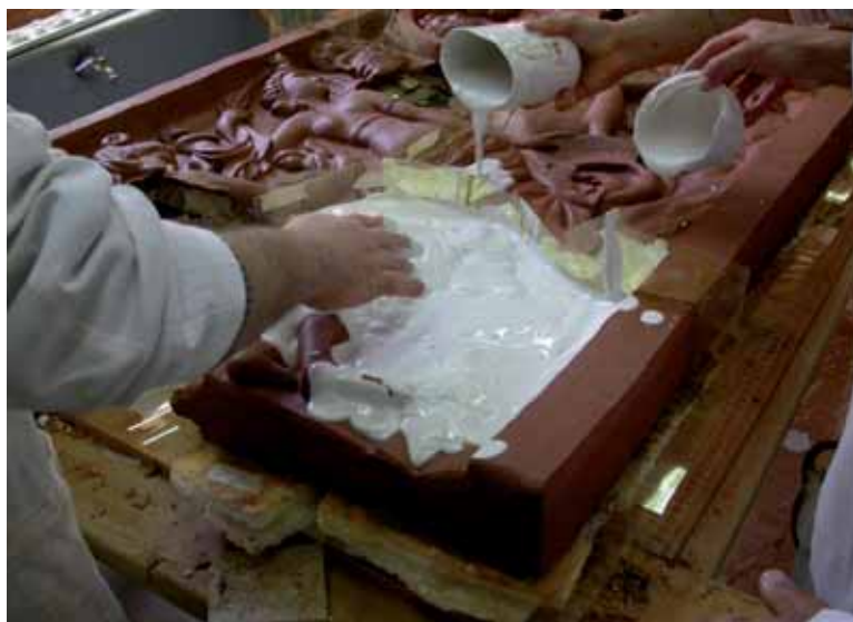
Figuras 17. División del modelado para realizar el molde por piezas
