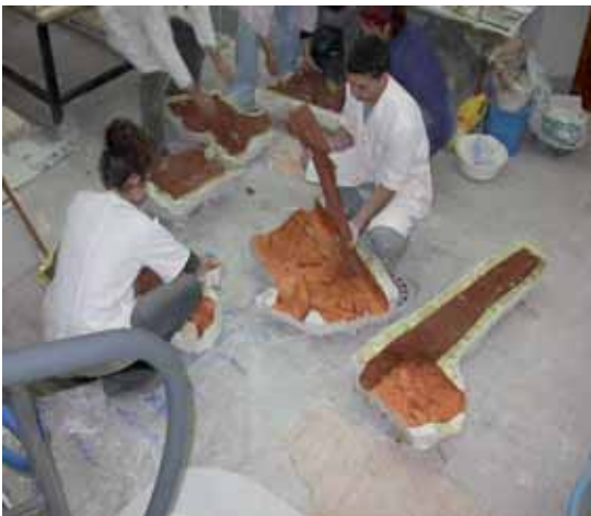
Figuras 22 y 23. Eliminación del barro y limpieza del molde
